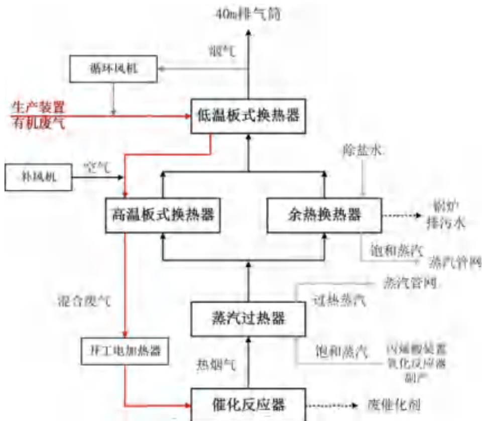
图 3.3-12 尾气催化氧化装置工艺流程图
